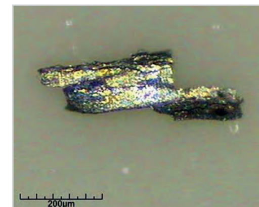
Metallischer Partikel aus dem Schraubengewinde
