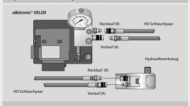
Im Lieferumfang: Hydraulikschläuche, Länge 5m (DN 6)
